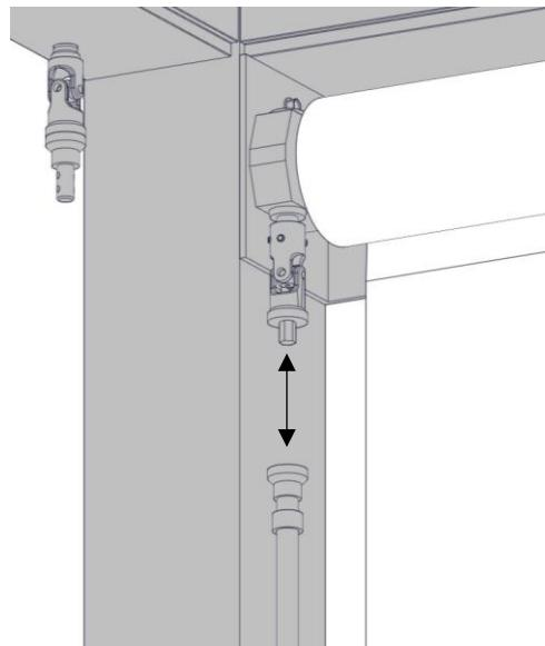
5-3 Fixation manivelle à fixer au mur ou sur le poteau de la pergola
