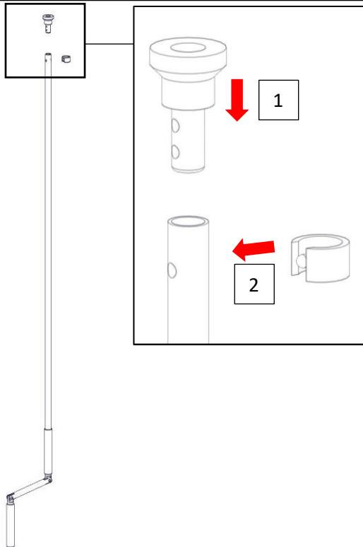
5-2 Base magnética : Manivela desmontable fácilmente
